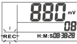
4. Para salir de la recuperación de memoria, pulse la tecla “REC” durante > 2 segundos para regresar al modo de medición. Se conservan todos los registros incluso si apaga el instrumento.
