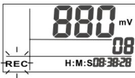
4. Um den Abfragemodus zu beenden und in den Messmodus zurückzukehren, die **REC**-Taste mindestens 2 Sekunden gedrückt halten. Alle Aufzeichnungen bleiben erhalten, selbst wenn das Messgerät ausgeschaltet wird.
