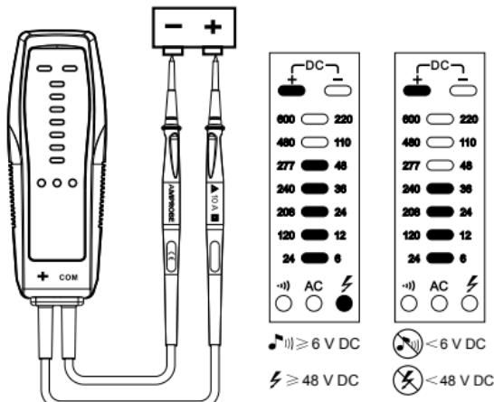
Figure 3 : Mesure de la tension +CC
