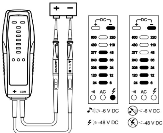
Figure 4 : Mesure de la tension -CC
