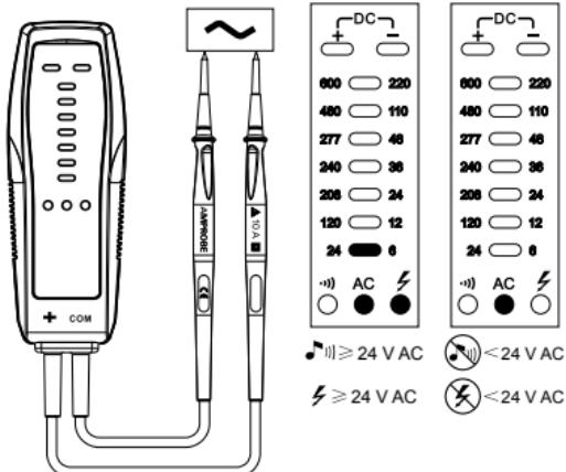
Figure 1 : Mesure de la tension CA
