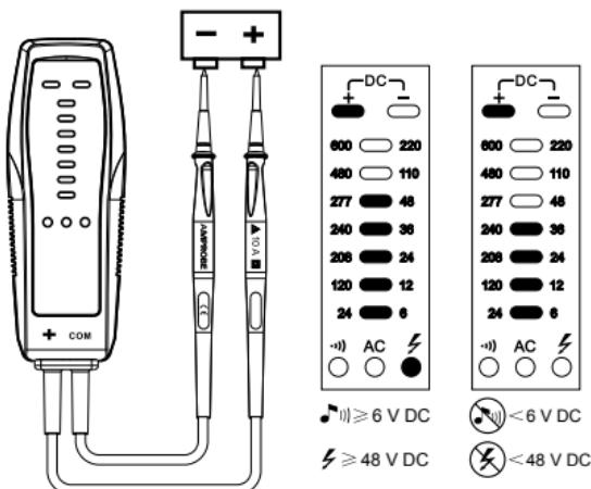
Imagen 3: medición de voltaje de CC+
