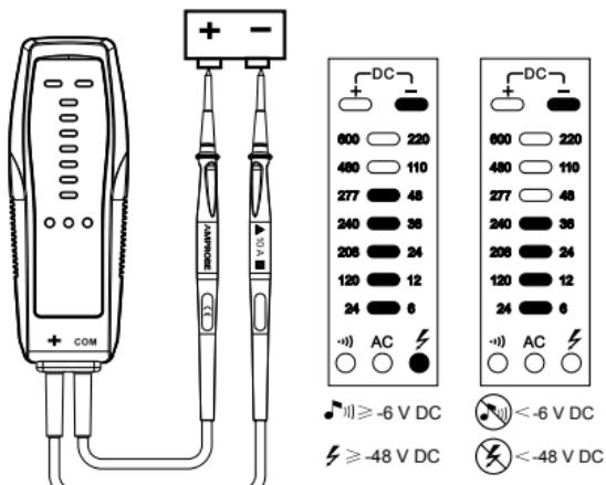
Imagen 4: medición de voltaje de CC-
