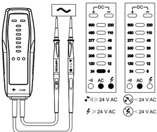
Imagen 1: Medición de voltaje de CA
