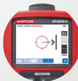
Le capteur Smart Sensor™ indique qu'il est aligné avec le câble sous tension. L'affichage indique la direction et l'orientation précises des câbles.
