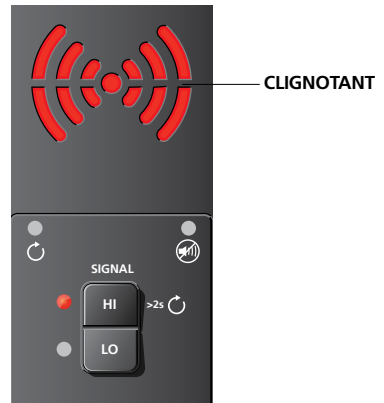
Figure 4.12b : Voyant du transmetteur indiquant un signal en mode boucle
