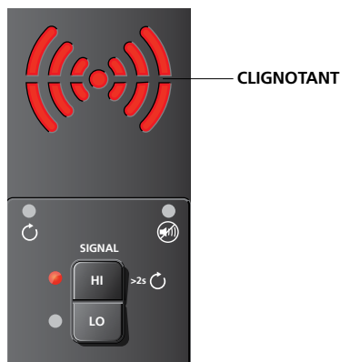
Figure 3.1b : Voyant du transmetteur indiquant un signal en mode ÉLEVÉ
